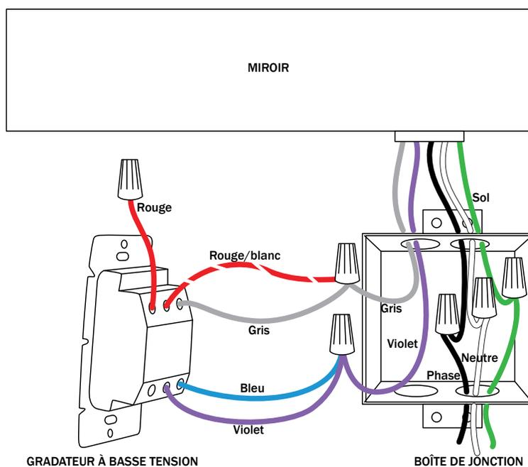
Diagramme de câblage pour l'installation du Gradateur Lutron Diva DDTV à Basse Tension
